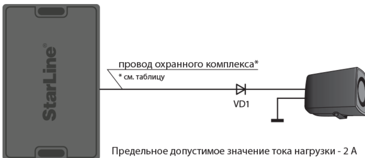
Рис. 1. Схема подключения автомобильной сирены
