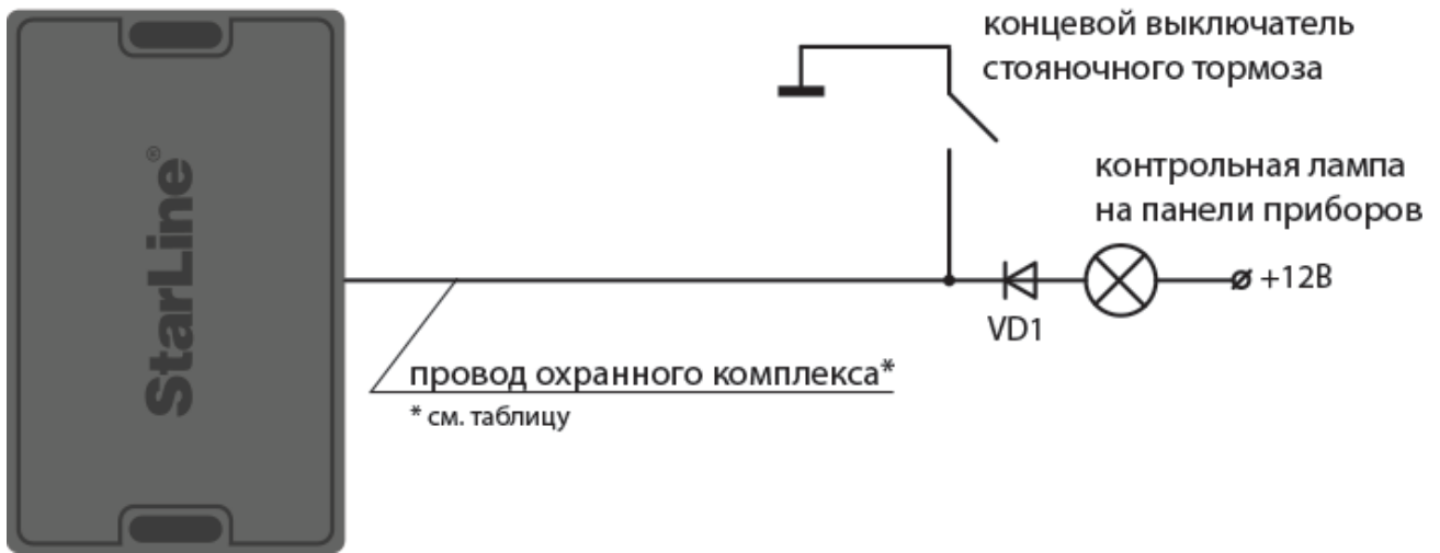
Рис. 4. Схема подключения стояночного тормоза
