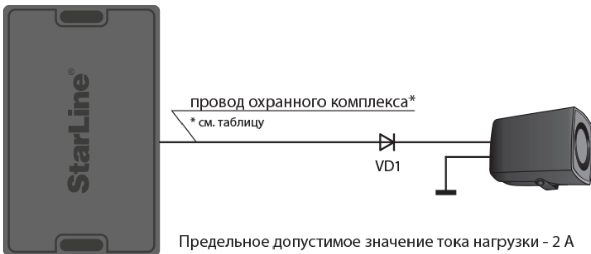
Рис. 1. Схема подключения автомобильной сирены
