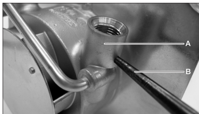
A Правый патрубок свечи B Острый предмет для чистки отверстия для подачи воздуха зажигания.
